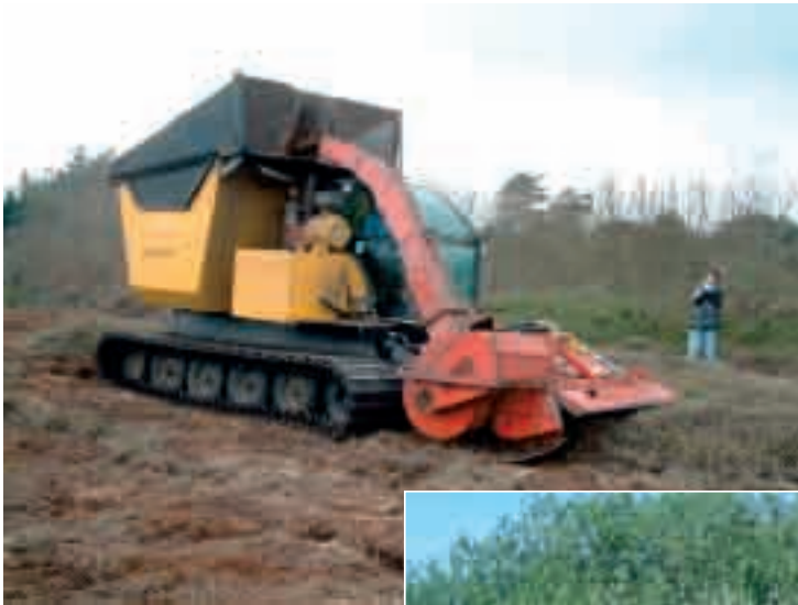
Prototipo ECOTRACK 200 realizzato dalla ditta TSI per conto della BON NatTec (Francia). Macchina trincia-raccoglitrice. (Foto D. Cuizzi)
