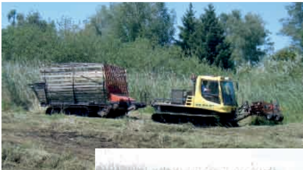
Battipista Kässbohrer Pisten Bully attrezzato con rimorchio raccogli- tore cingolato e andatrice dalla ditta NUP (Svizzera). Macchina andatrice- raccogliitrice. (Foto D. Cuizzi)
